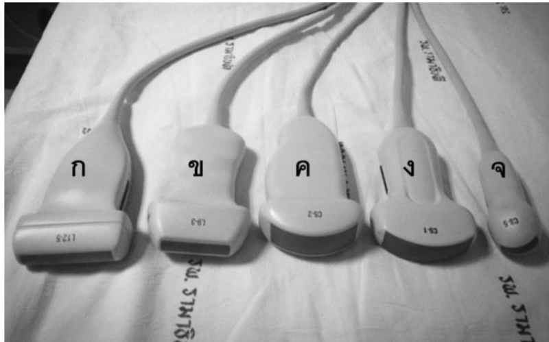
ภาพที่ 1-2. ตัวอย่างหัวตรวจชนิดต่างๆ ของเครื่องตรวจคลื่นเสียงความถี่สูงยี่ห้อฟิลิปส์ เรียงจากซ้ายไปขวา ได้แก่ (ก) หัวตรวจชนิดหน้าตัดตรง (linear-array probe) ในช่วงความถี่ 5.0-12.0 เมกะเฮิร์ตซ์ (ข) หัวตรวจชนิดหน้าตัดตรงในช่วงความถี่ 3.0-9.0 เมกะเฮิร์ตซ์ (ค) หัวตรวจชนิดหน้าตัดโค้ง (curvilinear-array probe) ในช่วงความถี่ 2.0-5.0 เมกะเฮิร์ตซ์ (ง) หัวตรวจชนิดหน้าตัดโค้งในช่วงความถี่ 1.0-5.0 เมกะเฮิร์ตซ์ (จ) และหัวตรวจขนาดเล็กชนิดหน้าตัดโค้ง (microconvex probe) ในช่วงความถี่ 5.0-8.0 เมกะเฮิร์ตซ์
