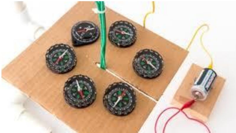
รูป 1.6 การทดลองที่แสดงให้เห็นว่าเส้นลวดที่มีกระแสไฟฟ้าจะมีสนามแม่เหล็กแผ่ออกมาโดยรอบ
