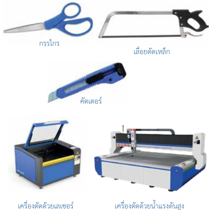
รูป 1.4 ตัวอย่างของอุปกรณ์และเครื่องมือที่ใช้สำหรับตัดวัสดุ
