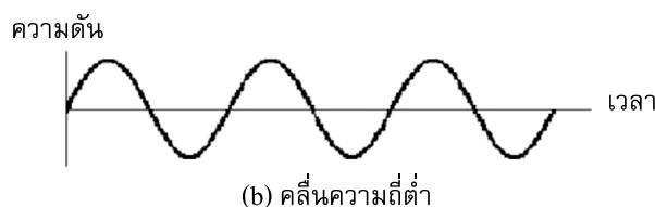
ภาพที่ 1.4 ความถี่ของคลื่นความถี่สูง (a) และคลื่นความถี่ต่ำ (b)
