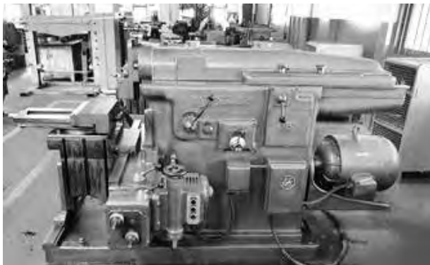
รูปที่ 1.2 เครื่องไส ที่มา : ถ่ายภาพโดยผู้เรียบเรียง
