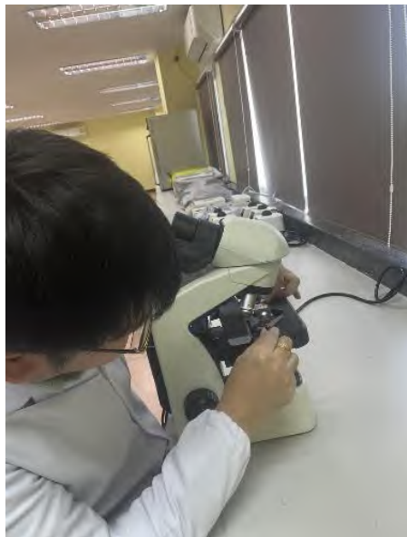
ภาพ แสดงการนำแผ่นสไลด์เข้าวางบนแท่นวางวัตถุ
