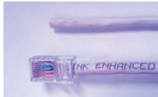
▲ ตัวอย่างสายสัญญาณ UTP และการเข้าหัวสายสัญญาณ UTP
