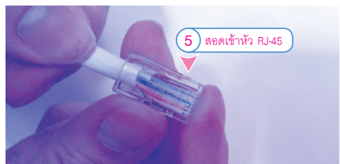
▲ การใส่สายสัญญาณเข้ากับหัว RJ-45 ตามมาตรฐาน 568B
