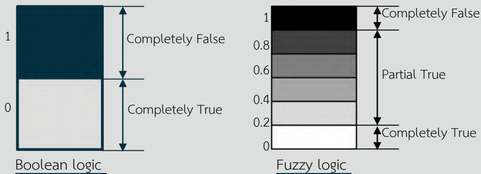
รูปที่ 1.17 เปรียบเทียบระหว่างตรรกะแบบบูลีนและตรรกะแบบคลุมเครือ
