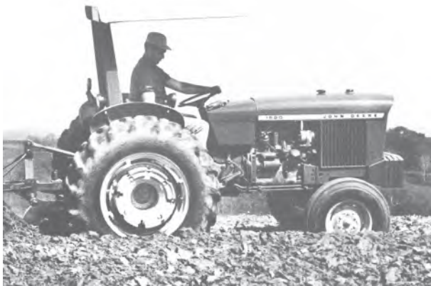
รูปที่ 1.40 โครงเหล็กสำหรับป้องกันคนขับขณะรถเกิดการหมุนกลิ้งหรือพลิกคว่ำ
