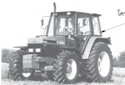
รูปที่ 1.42 การออกแบบห้องคนขับโดยอาศัยโครงเหล็กป้องกันการหมุนกลิ้งหรือพลิกคว่ำ (ก) และ (ข)
