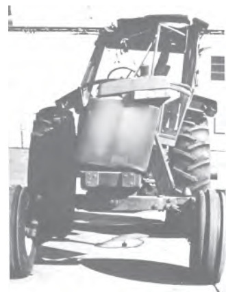
รูปที่ 1.41 เมื่อเกิดการพลิกคว่ำโครงเหล็กต้องแข็งแรงและไม่ยุบตัวลง
