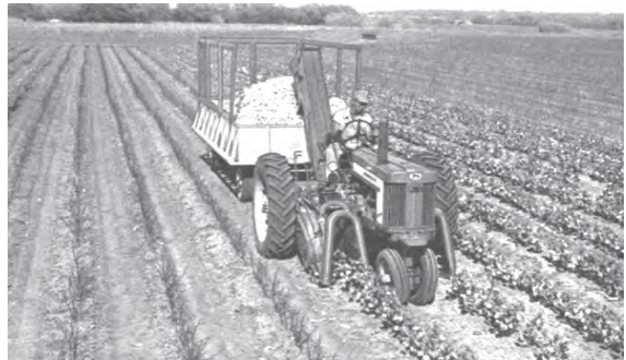
รูปที่ 2.4 แทรกเตอร์ที่ใช้กับพืชที่ปลูกเป็นแถวหรือระยะ (ซ้าย) ขณะเก็บเกี่ยวพืชในแปลง (ขวา)
