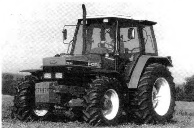
รูปที่ 2.8 การออกแบบห้องคนขับโดยอาศัยโครงเหล็กป้องกันการหมุนลี้หรือพลิกคว่ำ
