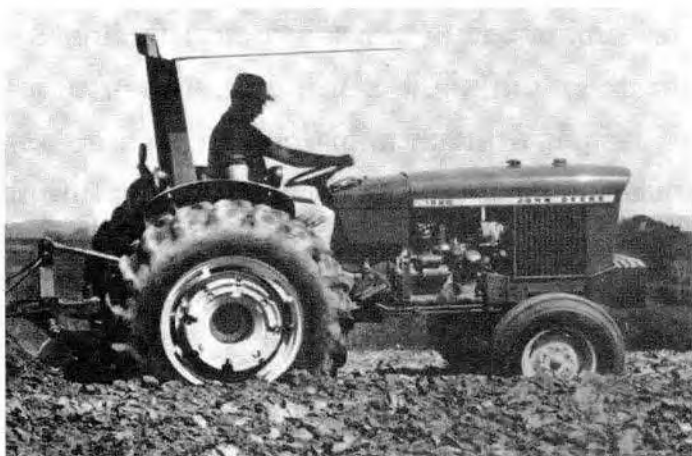
รูปที่ 2.6 โครงเหล็กสำหรับป้องกันคนขับ ขณะรถหมุนลี้หรือพลิกคว่ำ
