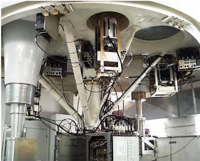
ภาพที่ 1.12 ห้องอุปกรณ์รับสัญญาณของกล้องโทรทรรศน์วิทยุกรีนแบงก์ ที่มา: Frayer (2024)
