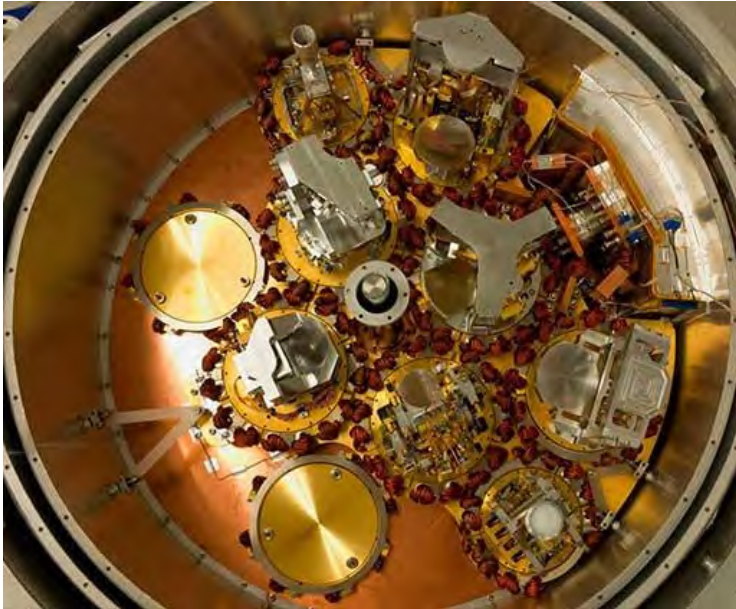
ภาพที่ 1.11 สายอากาศและส่วนรับสัญญาณวิทยุ ของกล้องโทรทรรศน์วิทยุ จานสะท้อน อาตากามา
