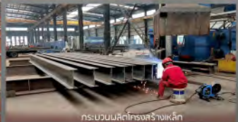
กระบวนการผลิตโครงสร้างเหล็ก
