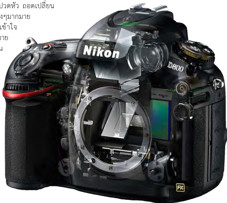
▲ ภาพแสดงส่วนประกอบภายใน ของกล้อง DSLR
