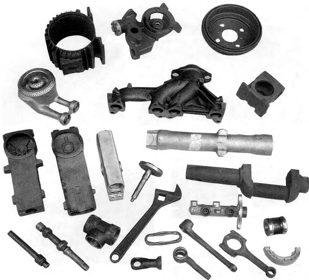
รูป 1.4 ชิ้นส่วนที่ผ่านขบวนการหล่อ การรีด การปั๊ม การ Forging ฯลฯ
