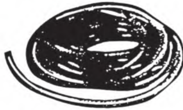
รูปที่ 1.4 ลักษณะของระดับน้ำแบบสายยาง
