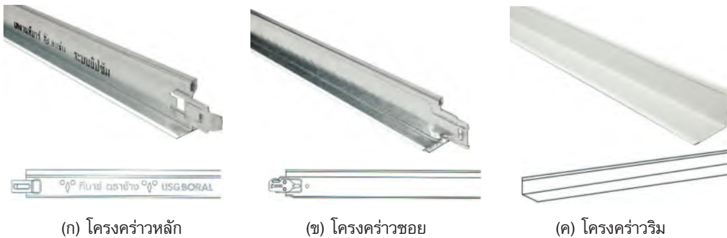
รูปที่ 1.17 โครงคร่าวฝ้าเพดานที-บาร์ (T-bar)
