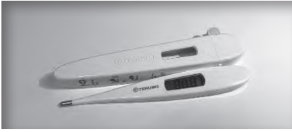
ภาพที่ 1 : ปุ๋กดิจิตอลสำหรับวัดทางรักแร้
