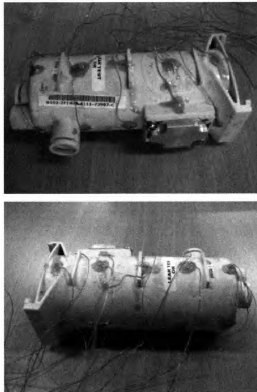
รูปที่ 1.13 ลักษณะการติดตั้งเทอร์โมคัปเปิลที่ผนังหม้อต้มของเครื่องทำน้ำอุ่น (ภาพโดย วิษุวัต มัชฌิมกะ)
