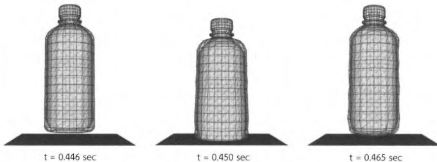
รูปที่ 1.24 การจำลองการปล่อยตกระบบป้องกันพลาสติกขนาดความจุ 500 ml จากระดับความสูง 1.0 m (ภาพโดย ชาคิต สุวรรณจรัส)
