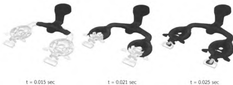
รูปที่ 1.23 การจำลอง CFD ของการไหลน้ำโลหะเข้าสู่เบ้ารูปร่างผาดังน้ำมันเชื้อเพลิงของแม่พิมพ์ ที่เวลาต่างๆ (ภาพโดย ปิยะนุช มีธรรม)
