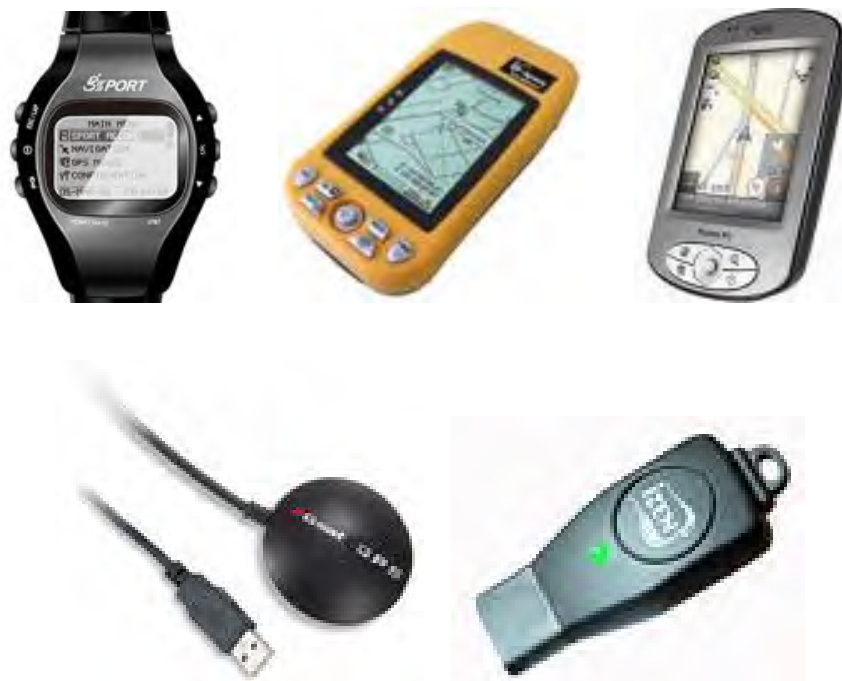
รูปที่ 1.3 แสดงลักษณะของเครื่องรับสัญญาณข้อมูลจากดาวเทียม GPS
