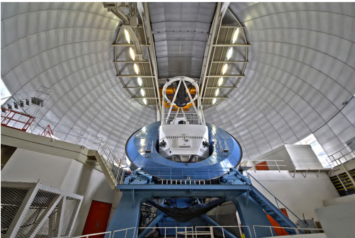
กล้องโทรทรรศน์ Nicholas U. Mayall โดยอุปกรณ์ DESI คือส่วนทรงกระบอกสีดำที่ติดอยู่ด้านบนของตัวกล้อง ที่มาภาพ : DESI
