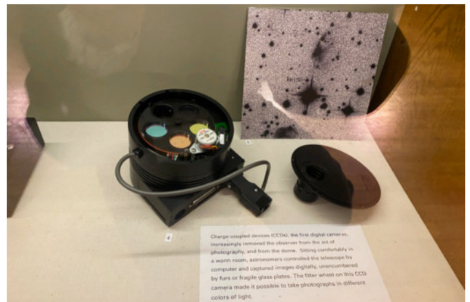
ภาพแสดงฟิลเตอร์ช่วงคลื่นต่างๆภายในกล้อง CCD โดยภาพนี้ถ่ายจากตู้แสดงโชว์ในหอดูดาวของ Wesleyan University
