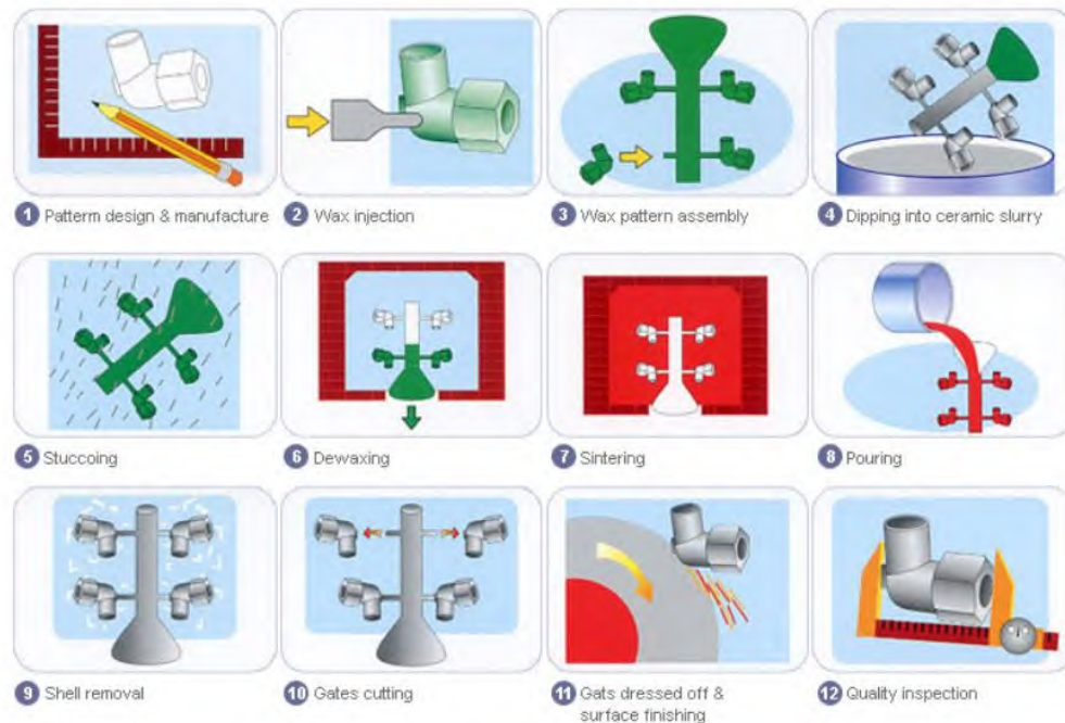
รูปที่ 2.5 กระบวนการหล่อได้ซึ่งสำหรับการผลิตโลหะ
