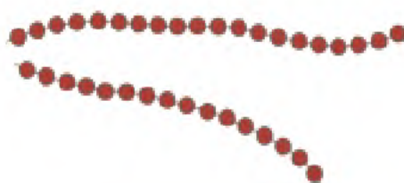
รูปที่ 1.37 รูปร่างการจัดเรียงโครงสร้างของวัสดุพอลิเมอร์แบบเส้น
