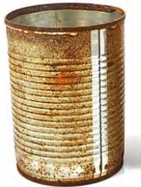
รูปที่ 1.66 ความบกพร่องเนื่องจากการสัมผัสบริเวณผิวด้านนอก
