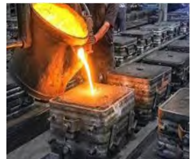
รูปที่ 2.3 ส่วนประกอบของกระบวนการหล่อวัสดุโลหะชนิดหล่อแบบทราย (sand casting)
