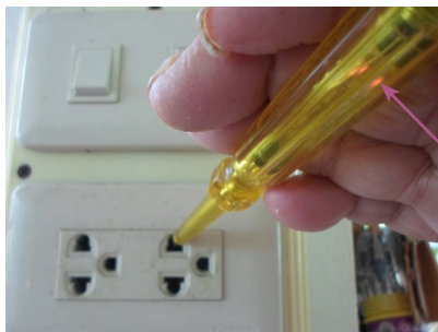
รูปที่ 1.4 การใช้ไชควงตรวจสอบไฟฟ้าเมื่อพบเส้นไลน์
