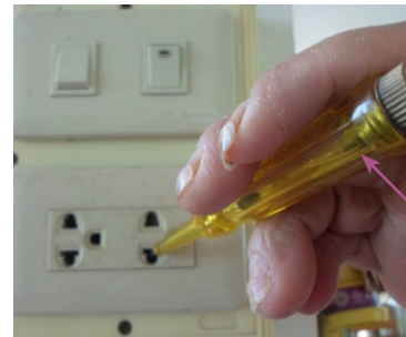
รูปที่ 1.5 การใช้ไชควงตรวจสอบไฟฟ้าเมื่อพบเส้นไม่มีไฟ
