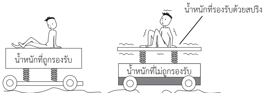
รูปที่ 1.8 แสดงการเปรียบเทียบระหว่างน้ำหนักที่ถูกรองรับด้วยสปริงและน้ำหนักที่ไม่ถูกรองรับด้วยสปริง
