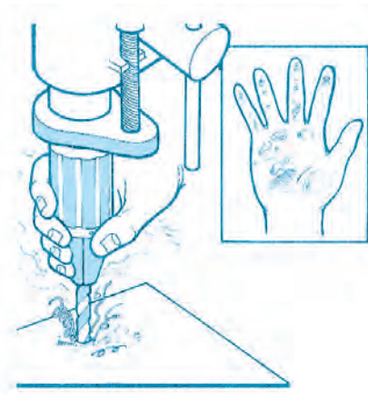
รูปที่ 1.2 แสดงอันตรายที่เกิดจากการปรับแต่งเครื่องจักรขณะทำงาน
