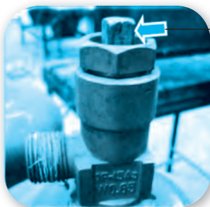
รูปที่ 1.25 แสดงวาล์วเปิด-ปิดถังบรรจุแก๊สอะเซทิลีน
