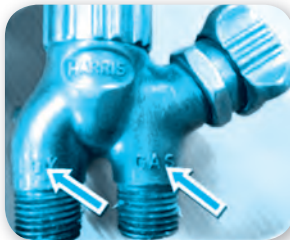
ข. ข้อต่อแก๊สออกซิเจนกับแก๊สอะเซทิลีน
