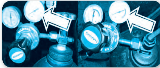
รูปที่ 1.28 แสดงเกจวัดความดันสูงแก๊สออกซิเจนและแก๊สอะเซทิลีน
