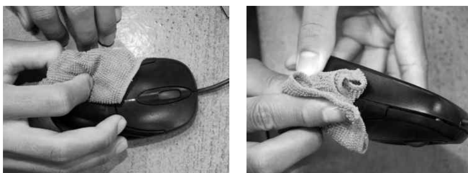
ภาพที่ 1.23 แสดงการทำความสะอาดเมาส์แบบแสง
