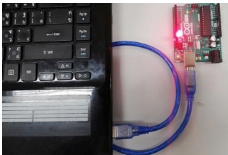
รูปที่ 1.13 ไฟกะพริบที่ขา 13 ของบอร์ด Arduino
