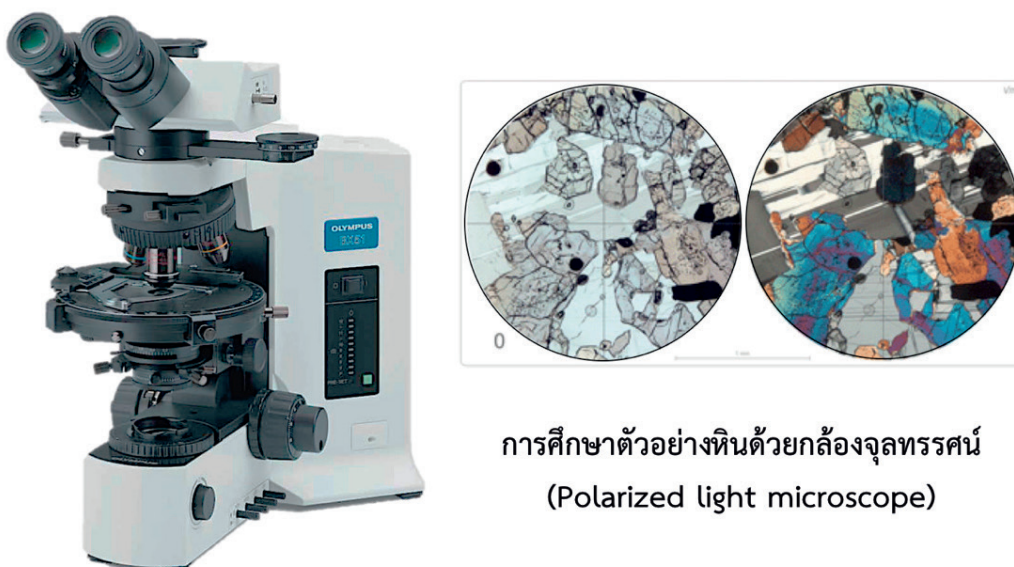
รูปที่ 1.8 กล้องจุลทรรศน์ (Polarized light microscope) และรูปถ่ายจากแผ่นหินบาง
