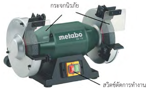
รูปที่ 1.3 อุปกรณ์ป้องกันอันตรายประจำเครื่อง
