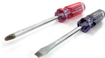
รูปที่ 1.12 แสดงลักษณะของไขควงปากแบนและปากแฉก
