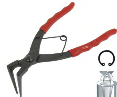
รูปที่ 1.17 แสดงลักษณะของคีมหุบแหวนล็อก
