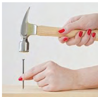
รูปที่ 1.29 หน้าตัดหัวค้อนขนานกับผิวหน้าที่ดี
