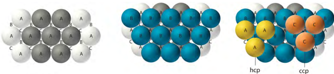
รูปที่ 1.14 การเกาะยึดตัวของอะตอม
