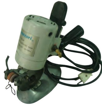
ภาพที่ 1.15 กรรไกรตัดผ้าใบมีดกลม ที่มา : ภาพถ่าย
