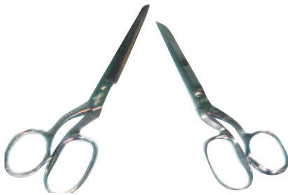
ภาพที่ 1.12 กรรไกรตัดผ้าด้ามตรง ที่มา : ภาพถ่าย
